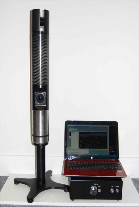
[ 그림 ] N-Visage 시스템. 스캐너, 제어 박스 및 노트북
